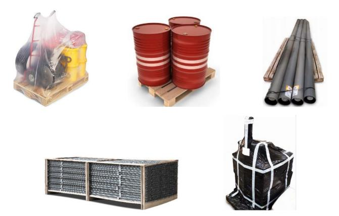
Bancali con parti sporgenti o che non permettano la sovrapponibilità in sicurezza di altra merce, quali possono essere quelli di taniche, tubi, macchinari, profilati, ecc., sono esempi ricorrenti di bancali che per le loro caratteristiche risultano essere fuori misura per forma e/o dimensioni (misure di base superiori a cm 120x120).
